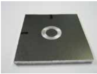
写真 1.スミフロンコート(0.5MPa 負荷後)写真 2.高機能フッ素コート( 2.5MPa 負荷後)
